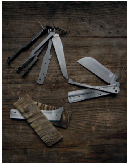
Zwei Furniture-Sätze bestehend aus Klinge, Korkenzieher, Ressort, Platinen – hier die neue, exklusiv für die Luxe-Serie gefertigte Furniture mit Widderhorn als Griffmaterial.
